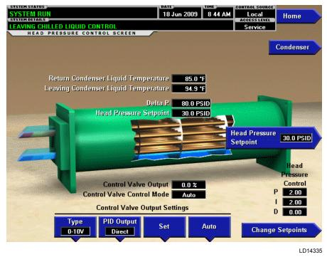
FIGURE 10 - HEAD PRESSURE CONTROL SCREEN (SOFTWARE VERSION C.OPT.01.21.307)
