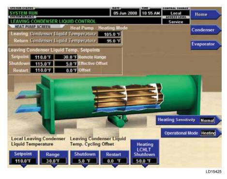
FIGURE 11 - HEAT PUMP SCREEN (SOFTWARE VERSION C.OPT.01.23.307 AND LATER)
