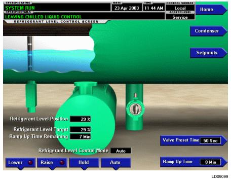
FIGURE 13 - REFRIGERANT LEVEL CONTROL SCREEN (SOFTWARE VERSION C.MLM.01.07.XXX TO C.MLM.01.10D.XXX OR C.OPT.01.10D (AND EARLIER))
