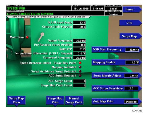
FIGURE 36 - ADAPTIVE CAPACITY CONTROL DETAILS SCREEN MODBUS PROTOCOL CONFIGURATION (SOFTWARE VERSION C.OPT.01.19.307 AND LATER)
