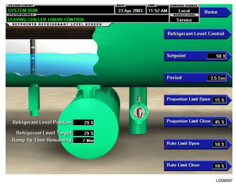
FIGURE 14 - REFRIGERANT LEVEL CONTROL SETPOINTS SCREEN (SOFTWARE VERSION C.MLM.01.07. XXX TO C.MLM.01.10D.XXX OR C.OPT.01.10D (AND EARLIER))
