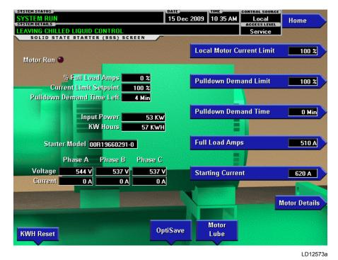
FIGURE 29 - MEDIUM VOLTAGE SOLID STATE STARTER SCREEN
