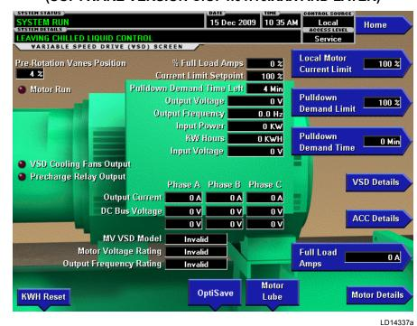
FIGURE 31 - MEDIUM VOLTAGE VARIABLE SPEED DRIVE SCREEN (SOFTWARE VERSION C.OPT.01.16. XXX AND LATER)
