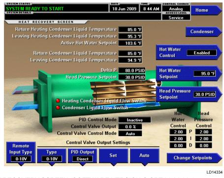
FIGURE 9 - HEAT RECOVERY SCREEN (SOFTWARE VERSION C.OPT.01.21.307)
