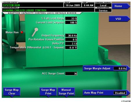
FIGURE 35 - ADAPTIVE CAPACITY CONTROL DETAILS SCREEN YORK PROTOCOL CONFIGURATION (SOFTWARE VERSION C.OPT.01.19.307 AND LATER)
