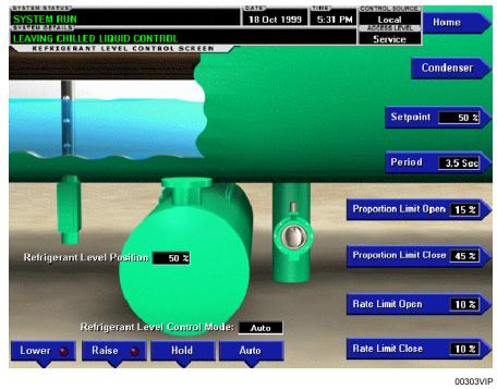
FIGURE 12 - REFRIGERANT LEVEL CONTROL SCREEN (FLASH MEMORY CARD VERSIONS C.MLM.01.06. XXX AND EARLIER)
